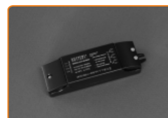
transformator TOPMET LED 10W • wej cie: 220-240V-50/60Hz • wyj cie: 12V DC eff, 800mA • zakres napi cia na wej ciu: AC 176V do 264V • max obci enie 10W • ochrona przed zwarcieciem KLP-1018HV
