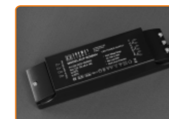
transformator TOPMET LED 50W • wej cie: 220-240V-50/60Hz • wyj cie: 12V DC eff, 4.16A • zakres napi cia na wej ciu: AC 176V do 264V • max obci enie 50W • ochrona przed zwarcieciem KLP-5018HV
